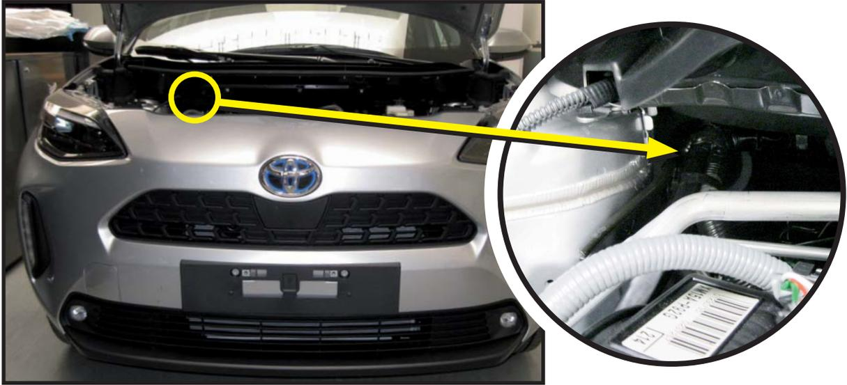
Fare passare i cavi per sensori seguendo il cablaggio originale fissandolo con fascette e nastro isolante.
